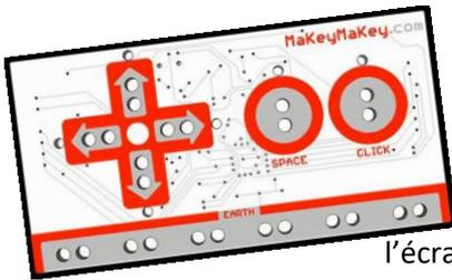
Le Makey Makey permet d'extensionner certaines touches du clavier en les reliant par des branchements de type alligator vers un objet conducteur d'électricité. L'exécution peut être faite avec n'importe quel logiciel, par contre, Scratch permet une foule de possibilités, car il peut faire intervenir du son, des enregistrements de notre voix, des animations à l'écran, etc. Voici un exemple simple :
