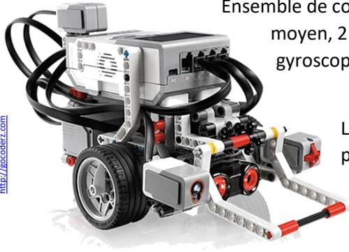
Ensemble de construction incluant : 1 concentrateur (cerveau), 2 grands moteurs, 1 moteur moyen, 2 capteurs de contact, 1 capteur de distance, 1 capteur de couleur, un capteur gyroscopique (mesure de rotation).
