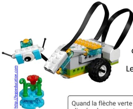
Ensemble de construction incluant : 1 concentrateur (cerveau), 1 moteur et 2 capteurs (distance et inclinaison)
